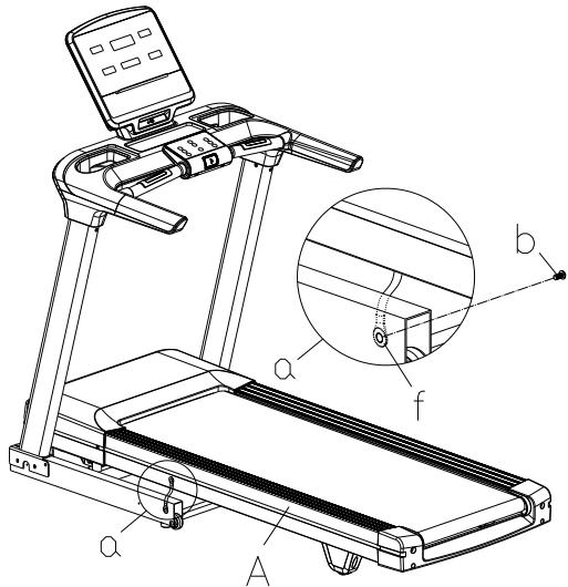
1. Витягніть болт M8 \* 15 (b) у нижній частині сталевого троса (f) за допомогою гайкового ключа B10.
