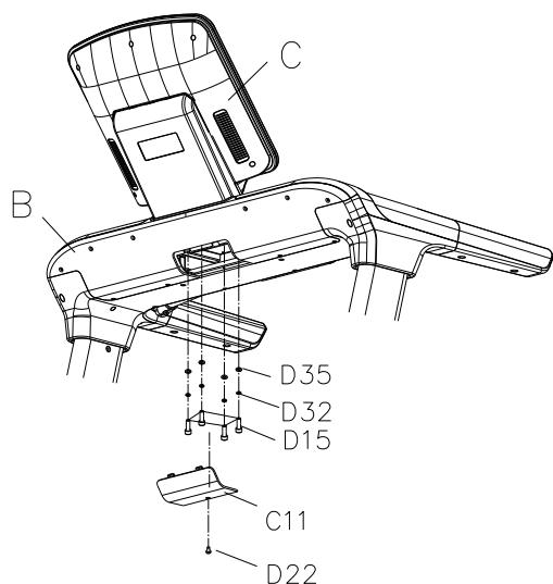
1. Зафіксуйте дисплей С на рамі підтримки дисплею В використавши болти 4\* D15, M8x15, пружинну шайбу 4\* D32 та плоску шайбу 4\* D35 за допомогою хрестового ключа В09.
