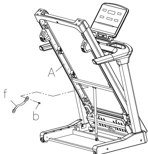
1. Витягніть болт M8 \* 15 (b) у верхній частині сталевого троса (f) за допомогою гайкового ключа 5 # B10. Потім зніміть сталевий трос з нижньої рамки.
